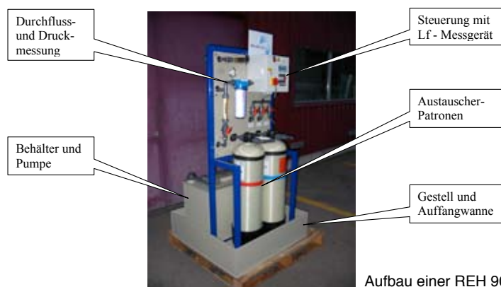
Aufbau einer REH 900 - Anlage
