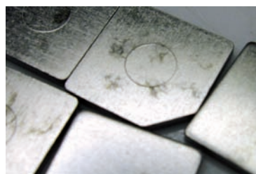
Bild 8: Spülfehler durch unzureichende Wasserqualität und -quantität werden häufig erst nach der Teiletrocknung oder gar erst bei Einsatz des Teiles sichtbar.
