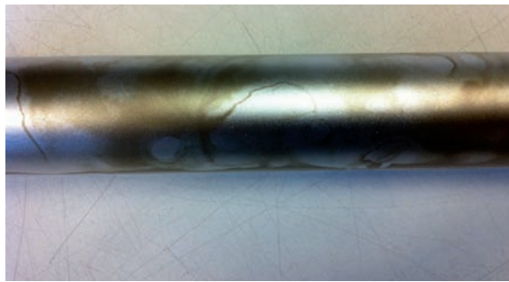
Bild 7: Viskose Prozesslösungen führen zu raschem Aufkonzentrieren der Sparspülen und somit zu fleckigen Rückständen auf der Werkstückoberfläche.
