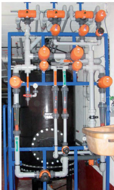
Bild 4: Kationenaustauscher zur Chromsäure-Reinigung
