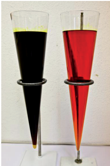
Bild 5: Chromelektrolyt vor und nach der Reinigung
