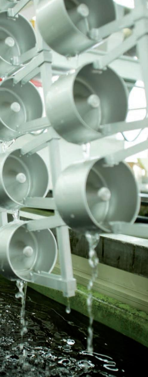
Spülvorgänge zwischen oder nach nasschemischen Prozessschritten sind entscheidend für die anschließende Oberflächenqualität.
