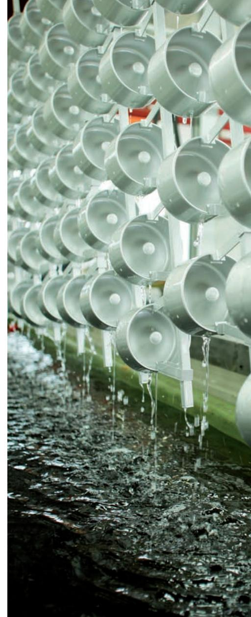
deren Hilfseinrichtungen mit dem Spülwasser dar. Die verschleppte Flüssigkeitsmenge, abgekürzt V mit der Konzentration an Chemikalien des Wirkbades ( $c_0$ ) wird beim Eintauchen in eine Spülung mit einer bestimmten Wassermenge (Q) verdünnt.
